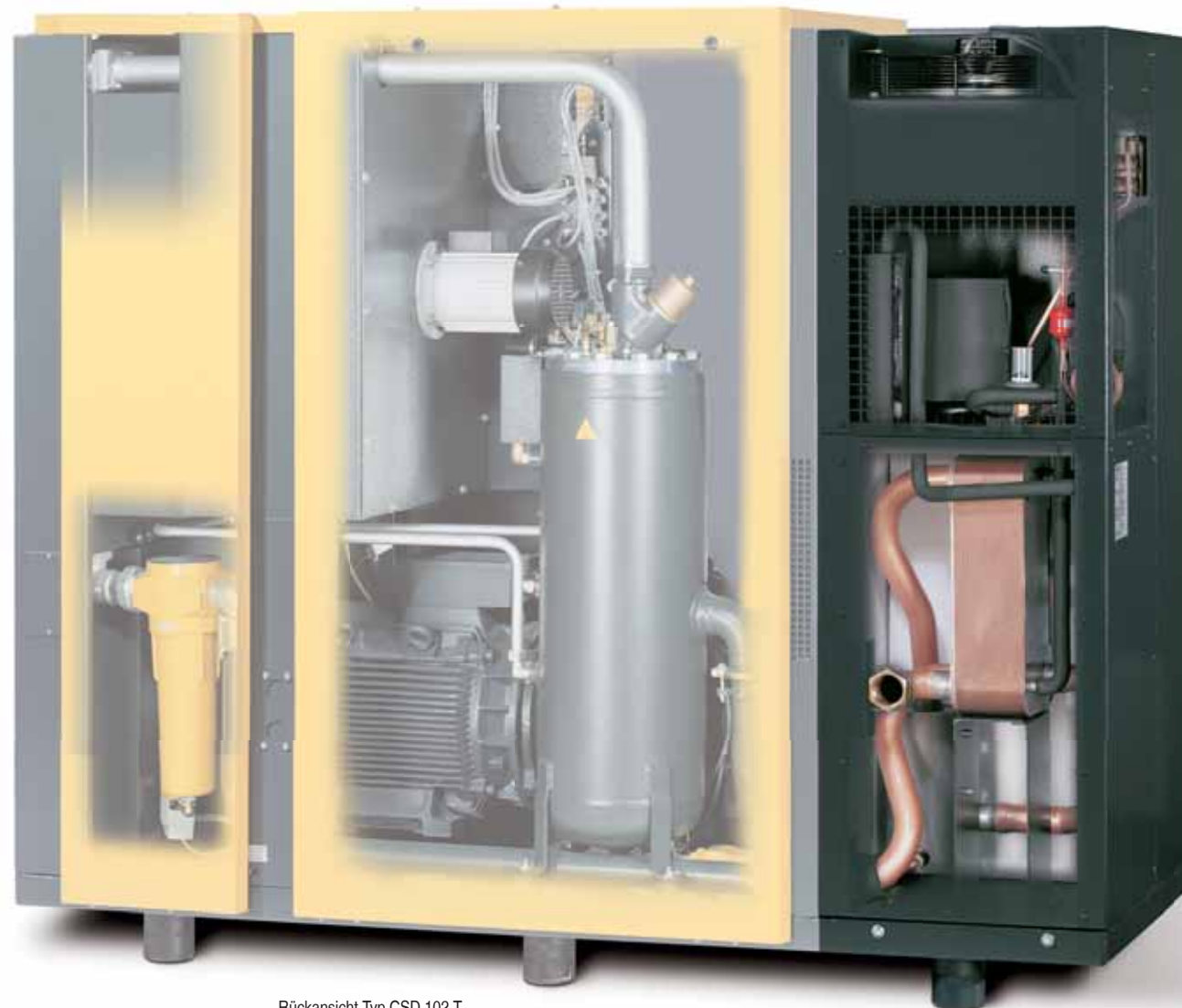
Die Illustration zeigt den Kältetrockner ohne Isolierung
