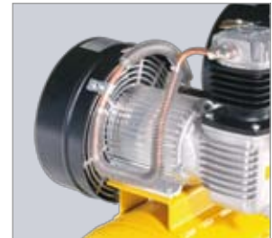
Direktgekoppeltes Aggregat Antriebsmotor direkt am Kompressorblock; robust und langlebig dank niedriger Drehzahl von nur 1500 U/min.
