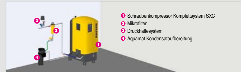
Druckluftstation mit SXC
